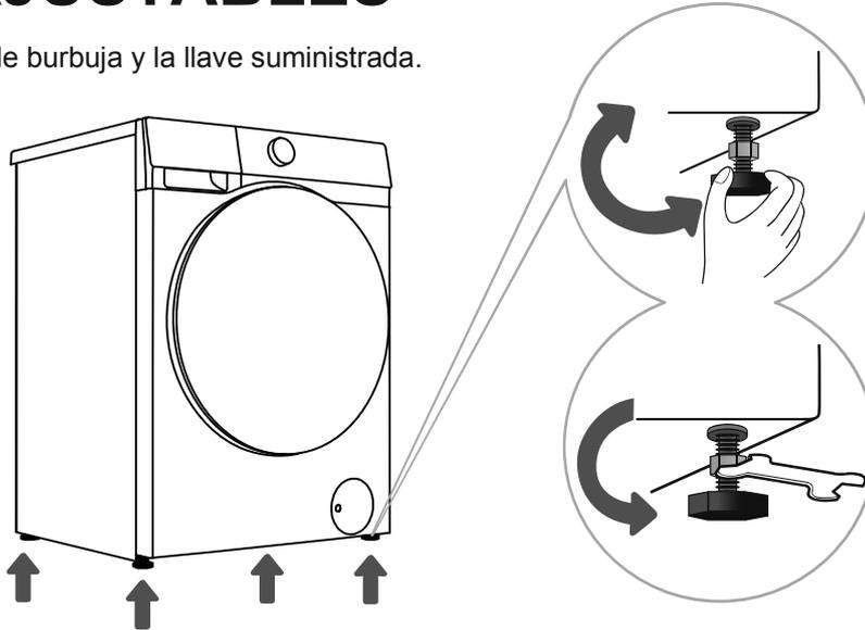
**1** Gire los pies ajustables para nivelar el aparato longitudinal y transversalmente. Los pies permiten una nivelación de +/-2 cm.
