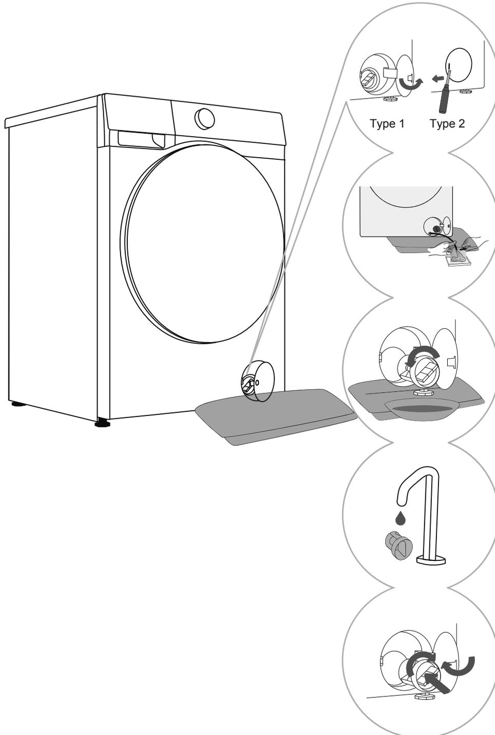
**1** Abra la tapa del filtro de la bomba. Tipo 1: Presione la tapa del filtro de la bomba para abrirla. Tipo 2: Utilice una herramienta adecuada (destornillador plano o similar) para Abrir la tapa del filtro de la bomba. (El tipo varía en función del modelo).
