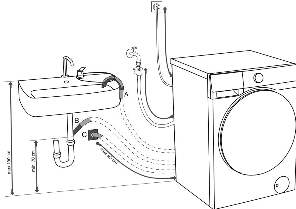
**A** El extremo de la manguera de descarga puede colocarse sobre un lavabo o una bañera. Utilice un cordel introducido por la abertura del soporte del codo para sujetar la manguera y evitar que se deslice hasta el suelo.
