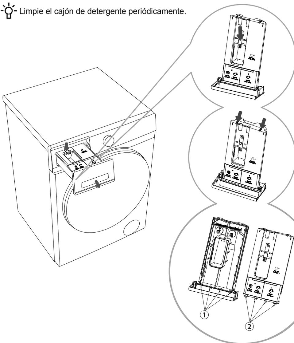
**1** Abra el cajón del dispensador de detergente, presione la palanca de límite como se muestra en la figura y extraiga el cajón de detergente.
