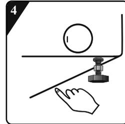
**1** Antes de instalar la placa de reducción de ruido, alinee y pegue la lana de absorción acústica con y a lo largo de la impresión en ángulo recto de la placa de reducción de ruido (este procedimiento no es necesario para algunos de los modelos sin lana de absorción acústica).
