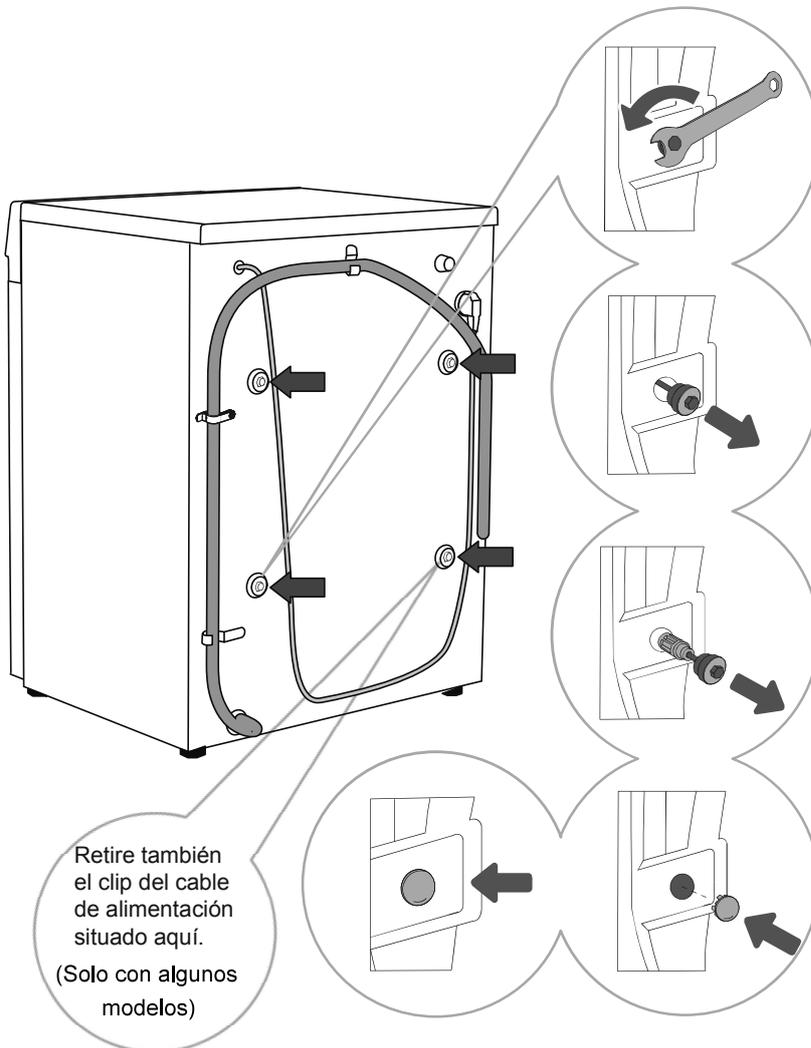
**1** Aparte las mangueras de descarga de agua y utilice una llave adecuada para aflojar los cuatro tornillos de la parte posterior en el sentido contrario al de las agujas del reloj. Afloje los tornillos unos 30 mm.
