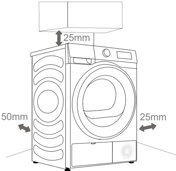
☞ La máquina no puede estar en contacto con una pared o mueble. Para un funcionamiento óptimo de la máquina, deje un poco de espacio alrededor de la máquina, como se indica en la figura. En caso de no dejar los mínimos espacios libres requeridos, esto puede provocar sobrecalentamiento.
