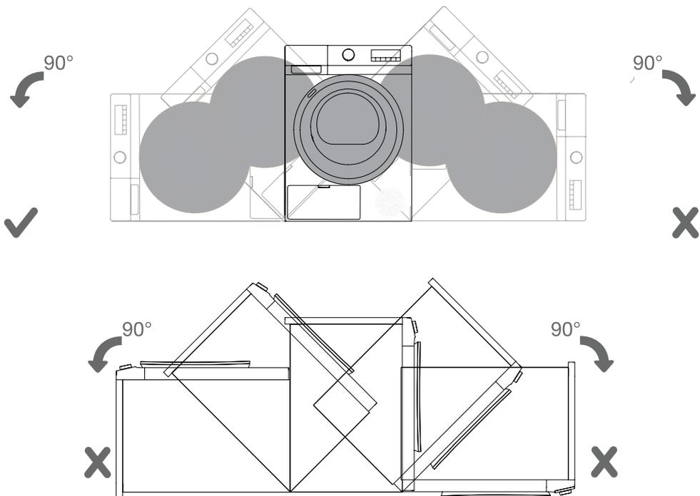
☀ Después de la instalación, espere 24 horas sin mover el aparato antes de usarlo por primera vez. Si la secadora debe estar apoyada sobre un lado durante el transporte o el mantenimiento, colóquela con su lado izquierdo que mire desde el frente del aparato hacia abajo.
