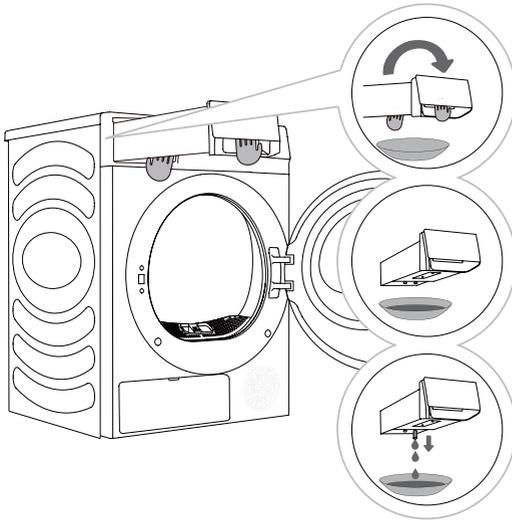
**1** Vuelva a mover el tanque del condensado de la secadora. Tire de la manija del depósito de agua con una mano hasta que el depósito esté a mitad. Una vez que el depósito de agua esté a mitad, apoye el fondo con la otra mano y continúe tirando suavemente con ambas manos.
