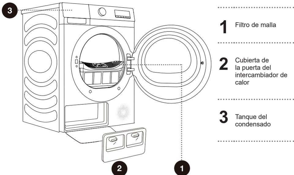
⚡ Nunca opere el aparato sin los filtros en su lugar o con los filtros dañados, ya que las fibras acumuladas de las telas podrían causar un mal funcionamiento o un fallo de la secadora.
