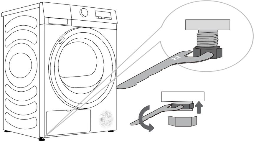
⚠ El piso sobre el cual se coloca la máquina debe tener una base de hormigón. Debe estar limpio y seco, de lo contrario, la máquina puede deslizarse. Además, limpie la parte inferior de los pies ajustables.
