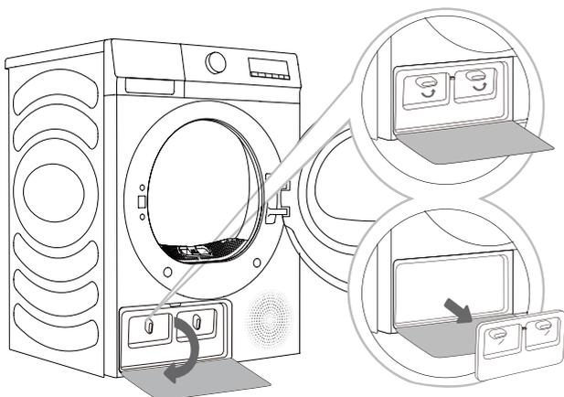
**1** Presione el broche de la cubierta de la puerta del intercambiador de calor en la izquierda inferior para abrir la cubierta de la puerta.
