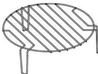
Rejilla de plancha (se utiliza sólo para la función de plancha o en combinación con microondas. Colóquela siempre en un plato de vidrio).
