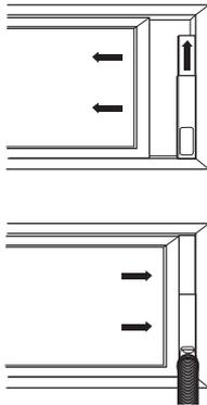
5. Inserte un tornillo de 1/2" (2 incluidos) en el orificio de la sección interior del deslizador más cercana al extremo de la sección exterior del deslizador
