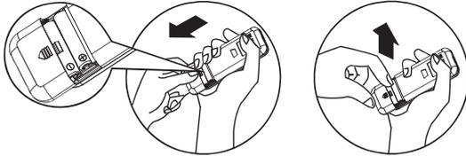
2. Inserte pilas nuevas asegurándose de que las marcas (+) y (-) de las pilas coincidan.
