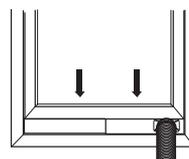
**NOTE:** Para encajonar la instalación de la ventana, se puede instalar verticalmente el equipo deslizador de ventana con la apertura abajo.
