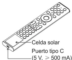
Puede cargar el mando a distancia exponiendo la celda solar a la luz del sol o usando un cable USB tipo C (no incluido).
