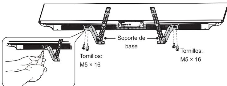
4. Retire la cubierta de la base e insértela en los dos soportes de la base como se muestra en la ilustración.
