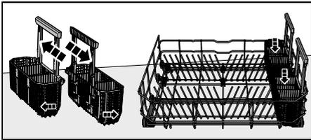
El cesto para cubiertos es flexible y se puede separar en dos partes, que luego se pueden acoplar en un lateral de la cesta inferior.
