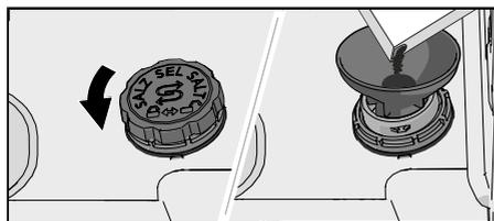
Si el agua utilizada tiene una dureza superior a 5 °dH (9 °fH / 6 °eH / 0,9 mmol/l), rellene con sal.
