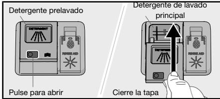
Si se utiliza detergente para lavavajillas en polvo o líquido, agregue una pequeña cantidad de detergente en el depósito para detergente prelavado.
