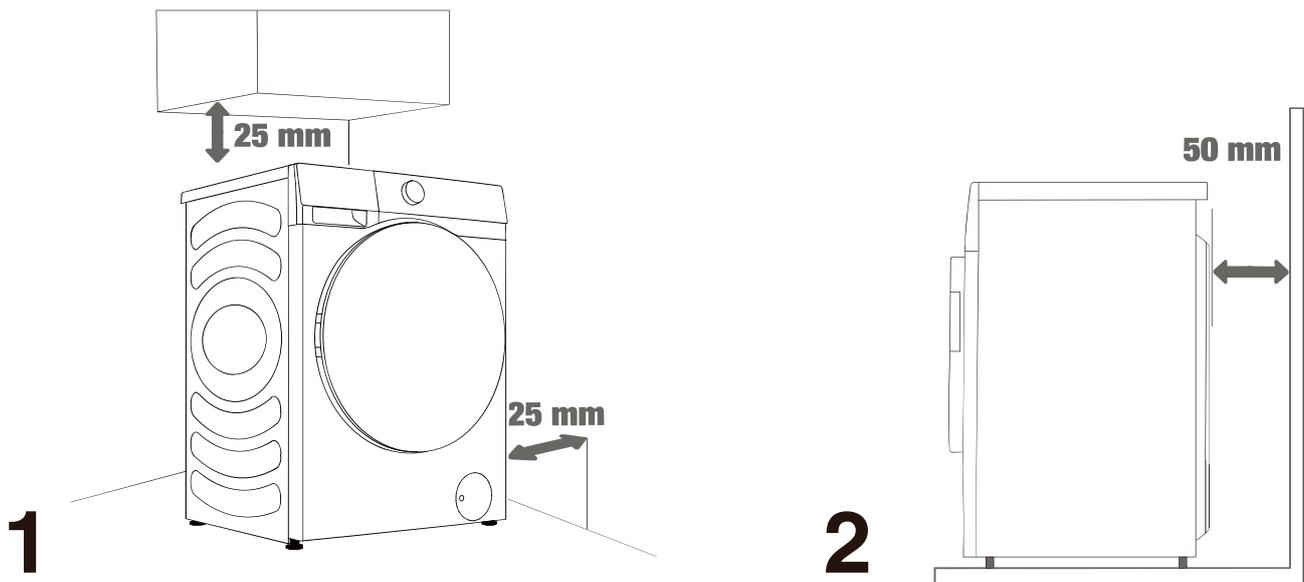
⚠ La lavadora secadora no debe estar en contacto con una pared o mueble. Para un funcionamiento óptimo de la lavadora secadora, deje algo de espacio alrededor de la lavadora secadora como se indica en la figura.
