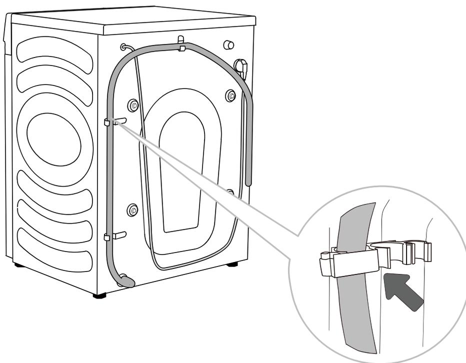
**D** La manguera de drenaje debe fijarse a los ganchos en la parte posterior de la lavadora secadora, como se muestra en la figura.
