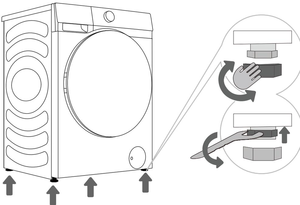
**1** Gire los pies ajustables para nivelar la lavadora secadora. Los pies permiten nivelación en +/- 2 cm.
