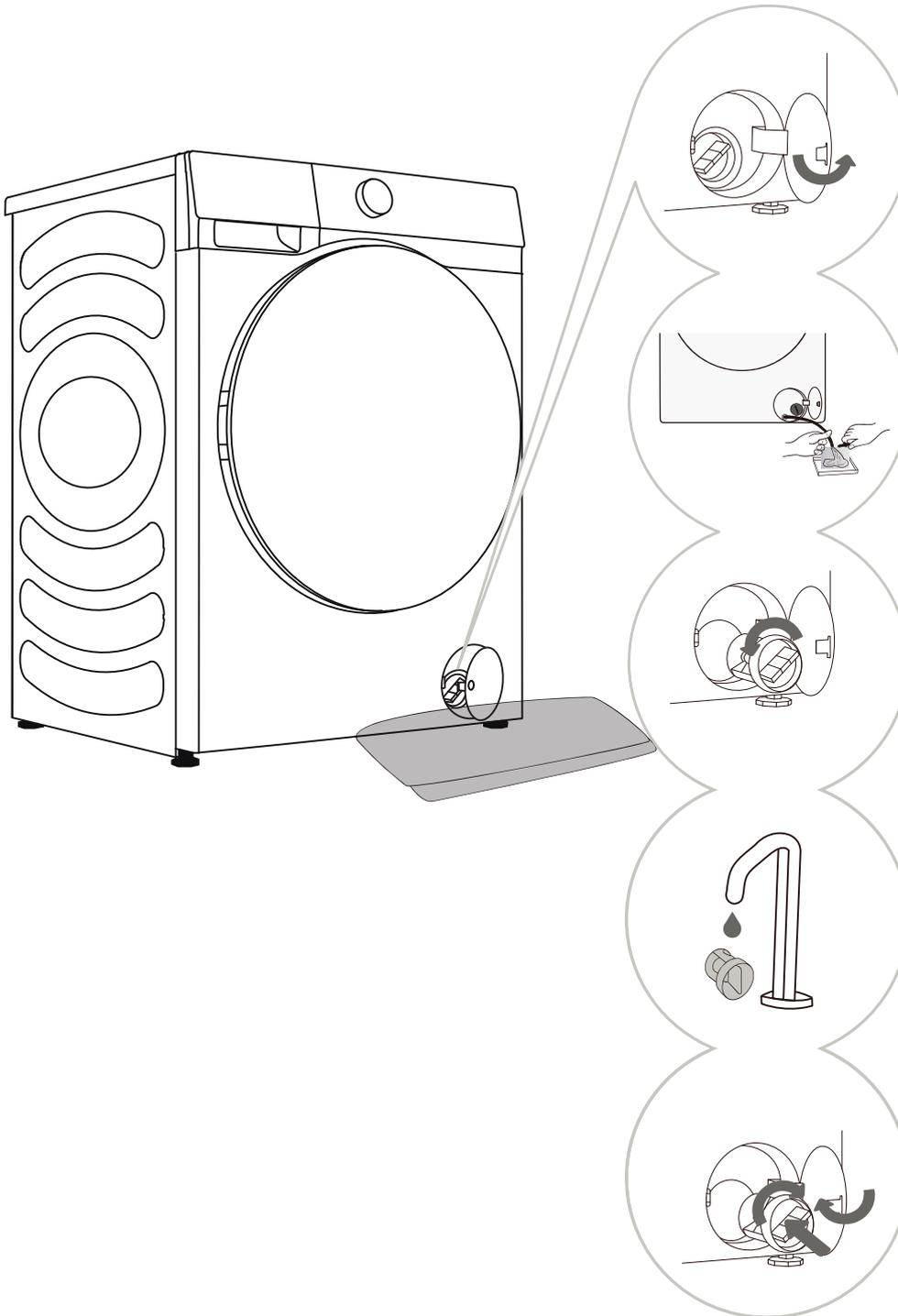
**1** Abra la tapa del filtro de bomba (presione la cubierta de la puerta y la tapa se abre).
