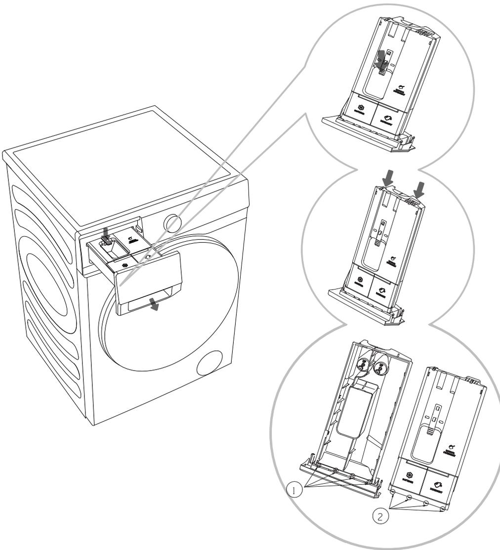
1. Abra el compartimiento del detergente, presione la palanca de límite como se muestra en la figura, y tire hacia fuera el compartimiento del detergente;
