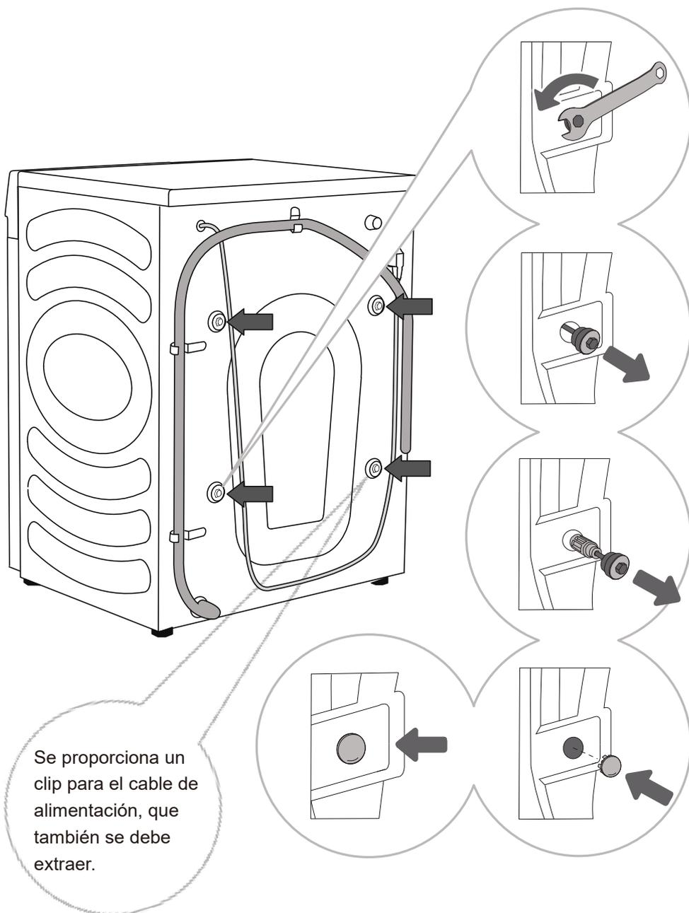
**1** Mueva a un lado las mangueras y utilice una llave de ajuste para aflojar los 4 tornillos en la parte posterior del aparato haciéndola girar en sentido antihorario, como se indica mediante la flecha. Aflojelos aproximadamente 30 mm (no por completo).
