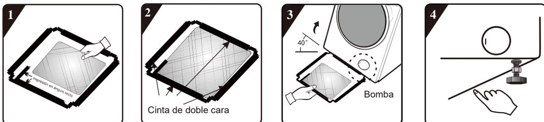
1. Antes de instalar el tablero de reducción del ruido, alinee y pegue la lana de absorción acústica a lo largo de la impresión en ángulo recto en el tablero de reducción del ruido (este procedimiento no es necesario para algunos de los modelos con lana de absorción acústica).
