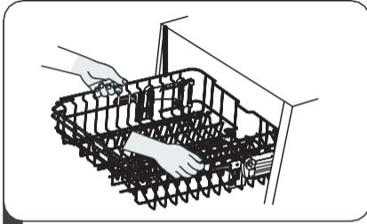
1 Para levantar la cesta superior, simplemente levántela en el centro de cada lado hasta que se traben en su lugar en la posición superior. No es necesario levantar la manija de ajuste.
