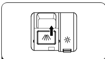
3 Cierre la solapa deslizándola hacia el frente y luego presionándola hacia abajo.
