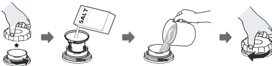
1. Retire la cesta inferior y desenrosque la tapa del depósito.
