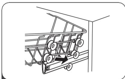
Volver a colocar la cesta superior en los rodillos superiores o inferiores.
