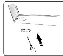
7. Cambie los cobertores de los orificios del tornillo en la placa del medio de izquierda a derecha (como se muestra en la imagen de arriba).
