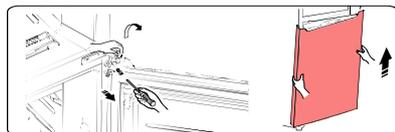
6. Coloque la puerta inferior sobre una superficie suave con los paneles hacia arriba. Afloje los tornillos ②, separe la pieza ①. Luego, instale la parte ① en la posición correspondiente en el lado izquierdo junto con los tornillos ②.
