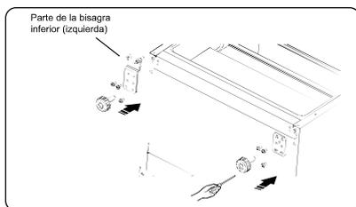
11. Mueva la puerta inferior y modifique su posición para alinearla con el orificio inferior y el eje de la bisagra superior. Gire la bisagra del medio a 180, cambie la arandela en el eje para el lado superior, modifique la bisagra del medio a la posición adecuada y luego instálela.
