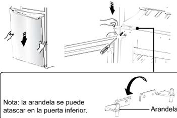
12. Desatornille el eje de la bisagra superior, gire la bisagra superior y fije el eje en ella. Luego, colóquela a un lado para utilizarla luego.
