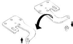
13. Vuelva al paso 2, cambie el cobertor de la bisagra superior ③ hacia la izquierda y fíjela con los tornillos ② y luego instale el cobertor ①. Por último, cambie el orificio del tornillo ④ hacia la derecha.
