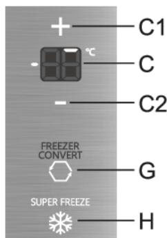
**Para activarla:** para activar la función de congelación intensiva (congelación rápida), presione la tecla **H**. Oirá un pitido y el indicador **SUPER FREEZE** se iluminará.
