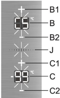
1. Cuando vea **CS** en la unidad de visualización **B**, presione brevemente la tecla **J**. El indicador **CS** y la tecla **J** comenzarán a parpadear. Comenzará una cuenta regresiva de 99 a 0 en la unidad de visualización **C**, indicando el progreso de la función. Después de 5 minutos, finalizará automáticamente.
