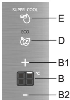
**Para activarla:** para activar la función de enfriamiento intensivo (super cool), presione la tecla **E**. Sonará un pitido y el indicador **SUPER COOL** se iluminará.
