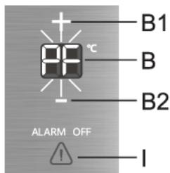
Si la temperatura en el aparato aumenta al nivel de alarma durante un corte de energía (falla de la fuente de energía), entonces la alarma de alta temperatura se activará cuando se restablezca la fuente de energía. Se activará la alarma acústica y **PF** parpadeará en la unidad de visualización **B** o **C** según el compartimento del aparato en el que la temperatura sea demasiado alta.
