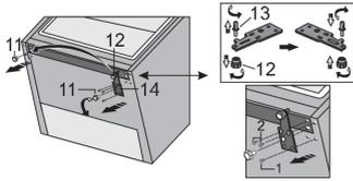
Afloje los tres tornillos de la bisagra inferior (14) y extráigala. Retire la pata adicional (12) del pasador de la bisagra inferior (13). Desatornille el pasador (13) de la bisagra inferior y atorníllelo en el lado opuesto de la bisagra, junto con la pata adicional (12).
