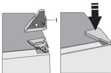
Volver a colocar la tapa de la bisagra superior (1).
