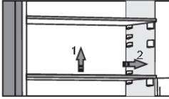
Puede colocar los estantes vacíos a su gusto utilizando las guías que hay en el interior del frigorífico sin tener que sacarlos del frigorífico. Para mover el estante o sacarlo del frigorífico, levántelo ligeramente por la parte trasera, tire de él hacia usted, y luego muévelo o sáquelo del electrodoméstico. Almacene los alimentos perecederos en la parte posterior del estante donde la temperatura es más baja.
