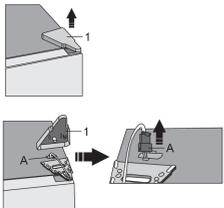
Retirar la tapa de la bisagra superior (1). Tenga especial cuidado de no dañar el conector (A). Desconectar el conector (A).
