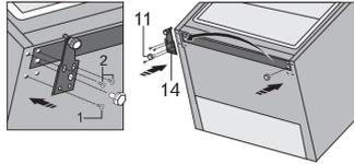
Fije la bisagra (14) en el lado opuesto, con los tornillos. Los tornillos deben colocarse en el orden que se muestra en la siguiente figura. Primero, ajuste el tornillo 1, seguido de los tornillos 2. Luego, atornille las patas ajustables (11).
