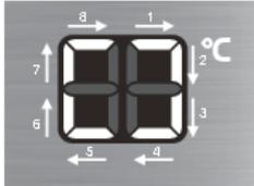
**Apagado del aparato:** para apagar el aparato, presione la tecla **A** y manténgala presionada por un momento (2 segundos). Volverá a sonar un pitido y los segmentos exteriores de los dígitos de la pantalla **B** se iluminarán en el sentido de las agujas del reloj. El aparato está en modo de espera (todavía está alimentado).
