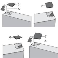
Quitar la tapa (6) del lado izquierdo de la puerta superior y sacar el conector (A) del espacio debajo de la tapa. Luego quitar la tapa (7) del lado derecho de la puerta superior. Colocar la tapa (7) en el lado izquierdo de la puerta superior y colocar la tapa (6) en el lado derecho de la puerta superior.
