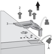
Desatornillar los tornillos (2) y retirar la bisagra (3). Pasar el conector (A) por el orificio de la bisagra. Sujetar la puerta durante el procedimiento para evitar que se caiga.
