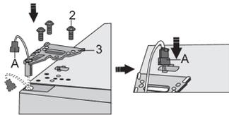
Colocar correctamente la puerta superior, pasar el conector (A) por el orificio de la bisagra superior (3) y ajustar con los tornillos (2). Sostenga la puerta superior en su lugar mientras los posiciona. Volver a conectar el conector (A).
