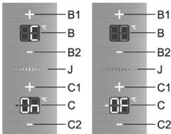
El estado de la función de mando a distancia (C) se indica en la unidad de visualización **C**.
