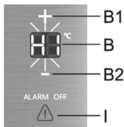
Si la temperatura en el electrodoméstico es demasiado alta, se activará una alarma acústica (tono intermitente), y **HI** parpadeará en la unidad de visualización **B** o **C** según el compartimento del aparato en el que la temperatura sea demasiado alta.
