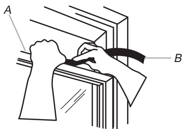
A. Parte superior do caixilho da janela inferior B. Vedação de espuma
