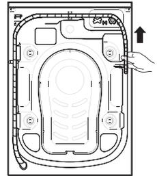
**12** Conecte la manguera de desagüe al sifón y engánchela sobre el borde de una pila empleando un codo. Si todavía no está montado, coloque el codo al final de la manguera de desagüe.
