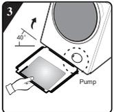
La máquina se inclina 40 grados, el lado con brecha de ángulo recto está hacia la parte frontal de la lavadora, el lado con brecha de bisel se inserta entre los dos tornillos de pie en la parte trasera de la lavadora hasta que esté insertado completamente, luego cierra el piso para que se pueda cercar del fondo de la lavadora.
