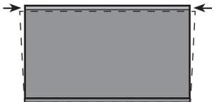
Si la parte superior de la imagen es más ancha que la pantalla, gire las patas delanteras izquierda y derecha en el sentido horario.
