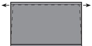
Si la parte superior de la imagen es más estrecha que la pantalla, gire las patas delanteras izquierda y derecha en sentido antihorario hasta que los bordes izquierdo y derecho de la imagen
