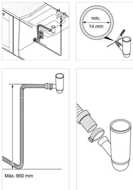
El tubo de desagüe también puede conectarse a una boquilla de unión del sifón del fregadero. La boquilla de conexión debe tener un diámetro interno de al menos 14 mm.
