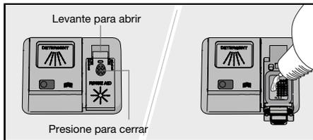
1. Abra la tapa del depósito de abrillantador.
