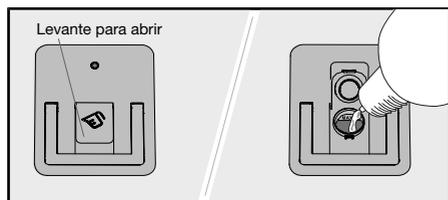
1. Abra la tapa del depósito de dosificación automática para el detergente lavavajillas en gel.
