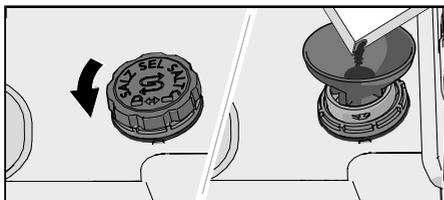
1. Retire la tapa del depósito de sal girándola en sentido contrario a las agujas del reloj.
