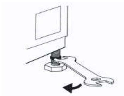
**Paso 2:** Levante un poco la lavadora y ajuste la altura de la base girándola.
