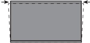
Si la parte superior de la imagen es más estrecha que la pantalla, utilice la llave inglesa para girar las patas traseras izquierda y derecha del Cine Láser en sentido horario, hasta que los bordes izquierdo y derecho de la imagen queden paralelos a los bordes de la pantalla.
