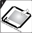
Antes de instalar el piso para eliminación de ruido, por favor pueda pegar el algodón de absorción de ruido a lo largo de la huella de presión rectangular en la placa de fondo (Para alguno modelo, no tiene algodón de absorción de ruido, por lo tanto omite este paso.).
