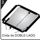
Quite el papel de la superficie y coloque la cinta de doble lado de los cuatro lados de la placa inferior.
