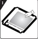
Antes de instalar la placa de reducción de ruido, alinee y pegue la lana de absorción acústica en toda la impresión del ángulo derecho de la placa inferior (este procedimiento no es necesario para algunos modelos que no disponen de lana de absorción acústica).
