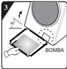
Incline la lavadora unos 40° y ponga la muesca del ángulo derecho hacia arriba en frente de la lavadora como se muestra en la figura. Inserte el lateral con la muesca del ángulo oblicuo entre dos tornillos de las patas traseras de la lavadora. Después, instale la placa inferior y asegúrese de que hace contacto estrecho con la parte inferior de la lavadora.
