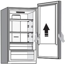
Retirar la puerta superior de la bisagra central levantándola con cuidado en línea recta hacia arriba. Colocar la puerta sobre una superficie lisa.
