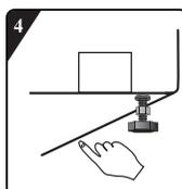
Pulse con mano las cintas adhesivas alrededor para que el piso para eliminación de ruido se adhiera a la caja, firmemente.
