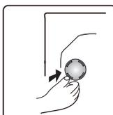
**Importante:** Guarde os parafusos de transporte e a chave para necessidade de eventual transporte do equipamento e, nesse caso, ponha novamente os parafusos, os apertando na direção contrária.
