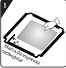
Antes da instalação da placa inferior de redução de ruído, cole o algodão de absorção de som na placa, alinhando-o com a marca de imprensa rectangular (Este passo será omitida para alguns modelos que não possuem algodão de absorção de som).
