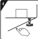
Pressione as fitas adesivas de dupla face à mão para colar a placa inferior de redução de ruído ao invólucro do aparelho.
