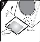
Incline a máquina por 40 °, faça com que a borda com aberturas rectangulares dê para a frente da máquina de lavar, insira a borda aberturas de ângulo oblíquo no espaço entre os parafusos dos pés inferiores na parte traseira da máquina de lavar até que a placa seja inserida completamente. Em seguida, feche a placa inferior para que a placa fique perto da parte inferior da máquina de lavar firmemente.
