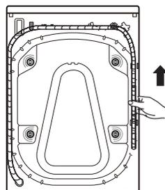
12 Conecte la manguera de desagüe al sifón y engánchela sobre el borde de una pila empleando un codo. Si todavía no está montado, coloque el codo al final de la manguera de desagüe.
