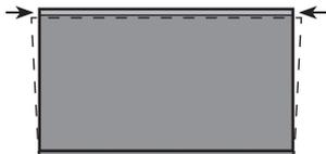
Si la parte superior de la imagen es más estrecha que la pantalla, entonces utilice la llave inglesa para girar las patas traseras izquierda y derecha del TV Láser en sentido horario, hasta que los bordes izquierdo y derecho de la imagen queden paralelos a los bordes de la pantalla.
