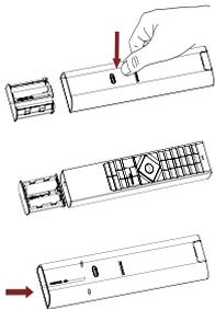
1. Pulse el interruptor y se abrirá la caja de pila automáticamente.
