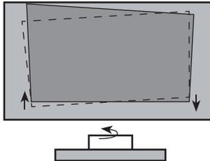
Si la parte inferior de la imagen está más baja en el lado derecho y más alta en el izquierdo, gire el dispositivo en el sentido de las agujas del reloj.
