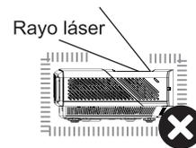
Deje, al menos, el espacio como se muestra en el diagrama de abajo para este dispositivo para tener una ventilación adecuada.
