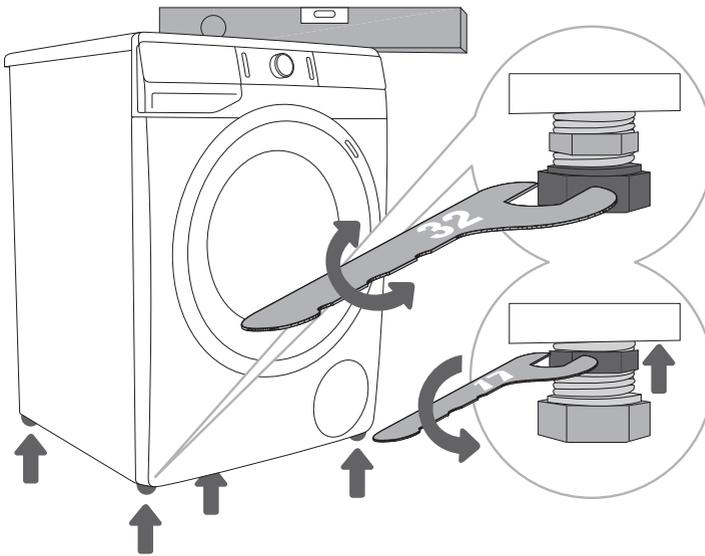
**1** Nivele la lavadora en dirección longitudinal y transversal girando las patas ajustables. Las patas permiten nivelar en +/- 1 cm.
