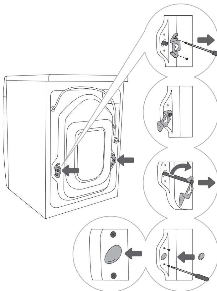
**1** Mueva las mangueras y quite los tornillos en la parte posterior de la lavadora.
