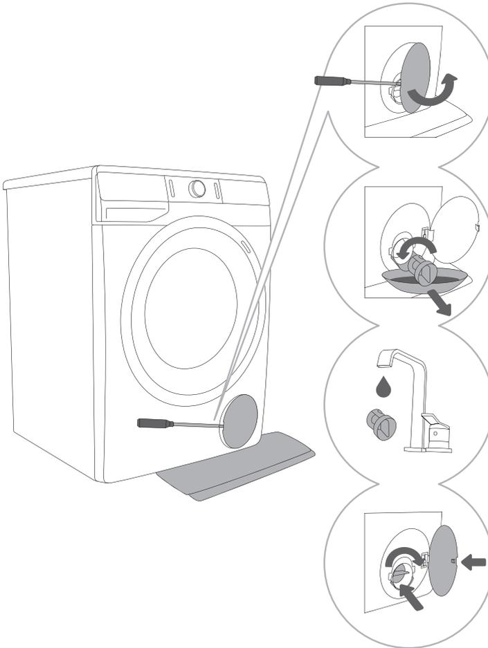
**1** Abra la tapa del filtro de la bomba utilizando una herramienta adecuada (un destornillador o una herramienta similar).
