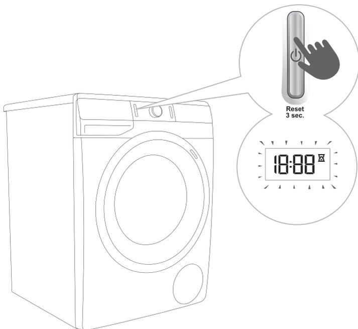
**1** Para detener e interrumpir el programa de lavado, presionar la tecla (1) ENCENDIDO/APAGADO/ **INTERRUPCIÓN (RESET)** y manténgalo presionado durante más de 3 segundos.
