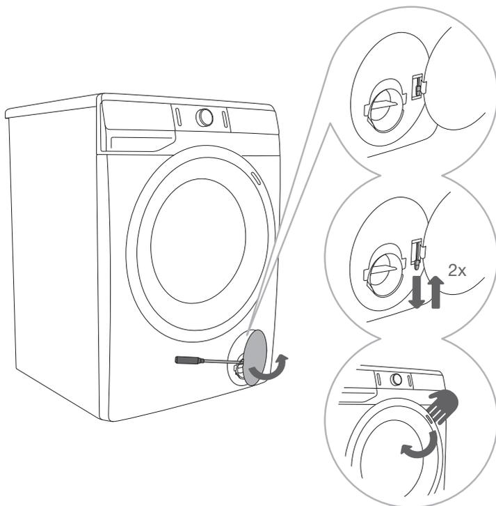
1 Cuando el programa se detenga o interrumpa, abra la tapa del filtro utilizando una herramienta adecuada (un destornillador o una herramienta similar).
