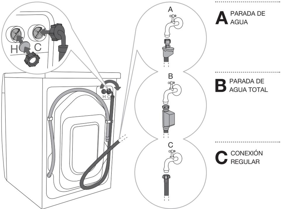
☞ Si su lavadora tiene una conexión de agua caliente y fría y solo desea conectarlo a un suministro de agua fría, no instale las tuberías de agua caliente y cierre la apertura para la conexión de agua caliente en la parte posterior de la lavadora con la tapa adjunta.
