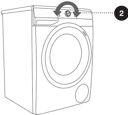
☼ Durante el funcionamiento, la perilla selectora de programa (2) no girará automáticamente.
