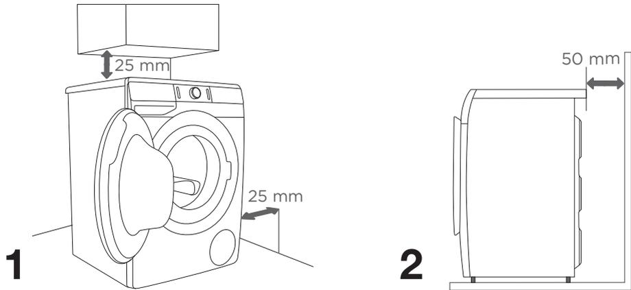
⚠ La lavadora no debe tocar la pared o los elementos adyacentes. Para un funcionamiento óptimo de la lavadora, se recomienda tener en cuenta las distancias de las paredes, como se muestra en la imagen.
