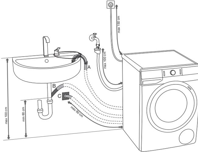
**A** El extremo de la manguera de descarga puede colocarse sobre un lavabo o una bañera. Use una cuerda que pase a través de la abertura en el soporte del codo para sujetar la manguera y evitar que se deslice hacia el piso.
