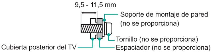
Siga las instrucciones proporcionadas con el soporte de montaje de pared.
