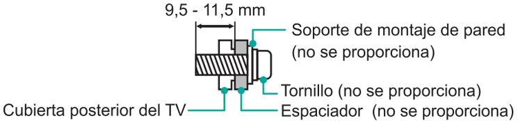
Siga las instrucciones proporcionadas con el soporte de montaje de pared.
