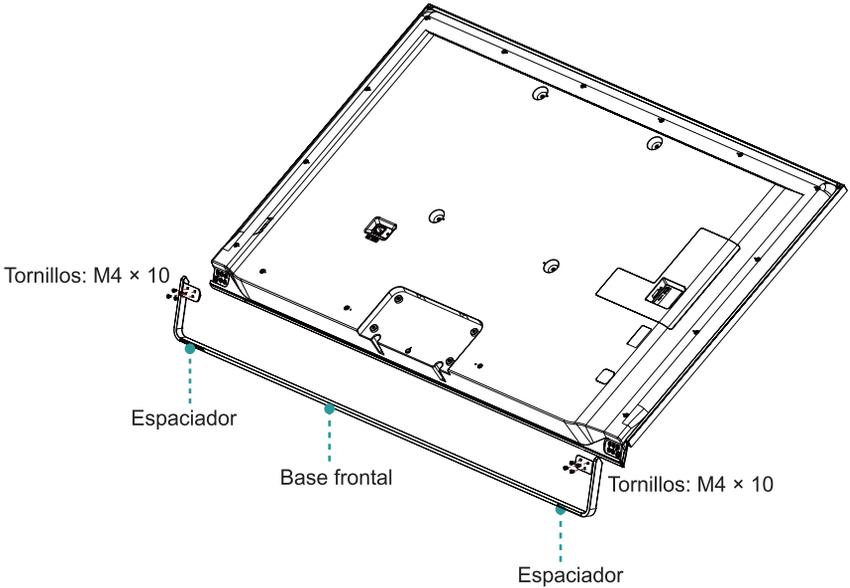
4. Saque la base trasera, asegúrela al TV con los 6 tornillos que se proporcionan en la bolsa de accesorios y, a continuación fije la placa de cubierta (adsorción del imán).
