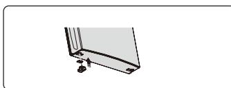
6. Er wordt losse schroeven gebruikt om het midden scharnier te bevestigen en dan verwijder het midden scharnier. Dan verwijder de onderste deur.
