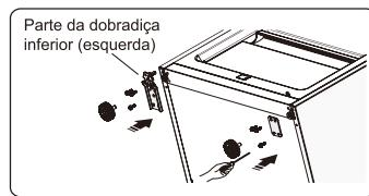
12. Mova a porta inferior e ajuste a sua posição para alinhar o local do orifício inferior e o eixo da dobradiça superior. Vire a peça da dobradiça do meio 180 graus, mude a arruela no eixo para o lado superior, ajuste a dobradiça do meio para a posição adequada e depois instale-a.
