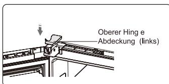
16. Wenden Teil ① um 180 ° und installieren Sie sie auf der rechten Ecke der oberen Tür, dann montieren Teil ②. (beide in Schritt 2 entnommen)
