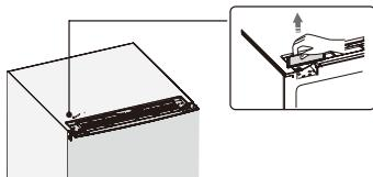
4. Entfernen Sie die Schrauben ① und entfernen Teil ②.
