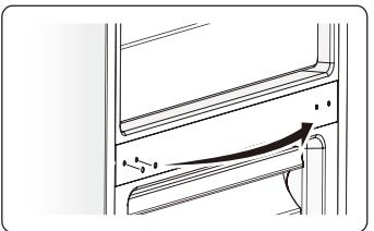
9. Placez le réfrigérateur platement, retirez la partie ③ et puis desserrez les vis ④. Retirer la partie ① et la partie ②.
