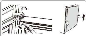
7. Coloque la puerta inferior en una superficie blanda con el panel hacia arriba. Afloje los tornillos ③, saque la pieza ② y la pieza ①. Gire la pieza ① 180° y, a continuación, monte la pieza ① y ② en la posición correspondiente del lado izquierdo usando los tornillos ③.
