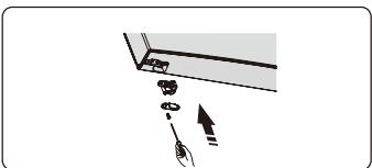
8. Cambiare i coperchi dei fori delle viti sulla copertura del piano medio da sinistra a destra (come mostrato nella figura).
