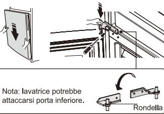
13. Svitare L'asse cerniera superiore, ruotare la cerniera superiore sopra e fissare l'asse su di esso. Poi metterlo a lato per l'uso.
