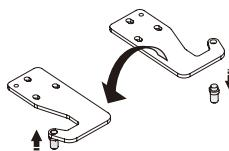
14. Coloque la puerta en la posición adecuada, ajuste la pieza① y la puerta superior. A continuación, sujeté la pieza① con los tornillos② . (Sujete la puerta superior con la mano durante el montaje)
