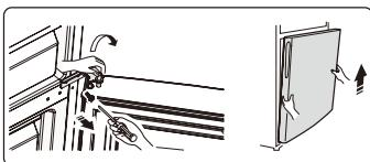
7. Coloque a porta inferior numa superfície macia com o painel virado para cima. Desaperte os parafusos ③, separe a parte ② e a parte ①.
