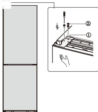
15. Installare parte il coperchio della cerniera superiore (che è nel sacchetto di plastica).
