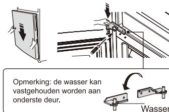
13. Schroef de bovenste scharnier-as uit, draai het bovenste scharnier over en bevestig de as erop. Plaats het dan aan de zijkant voor gebruik.
