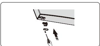
8. Mude as coberturas do orifício para parafusos na placa de cobertura do meio da esquerda para a direita (conforme ilustrado na imagem abaixo).
