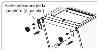
12. Déplacez la porte inférieure et ajustez sa position pour aligner la place du trou inférieur et monter l'axe de la charnière supérieure. Tournez la charnière du milieu de 180, changez la rondelle sur l'axe de la face supérieure, réglez la charnière centrale à la position appropriée, puis l'installez.
