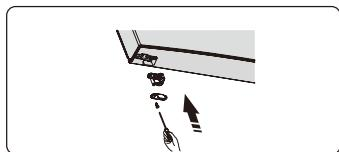
8. Ändern die Decke des Schraubenlochs auf Mitte der Deckplatte von links nach rechts (wie in der Abbildung unten gezeigt).
