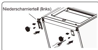
12. Bewegen Sie die untere Tür und stellen den Standpunkt, um das untere Loch und oberen Scharnierachse auszurichten. Drehen Sie das mittlere Scharnier um 180, ändern Sie die Scheibe auf der Achse auf der oberen Seite, passen Sie das mittlere Scharnier in die entsprechende Position und dann installieren.
