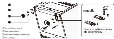
10. Svitare la cerniera inferiore, metterlo nella parte del foro e avvitare e montare la rondella.
