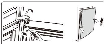
7. Legen Sie die untere Tür auf einer glatten Oberfläche mit seiner Verkleidung nach oben. Lose Schrauben ③ lösen und Teil ② ① Teil. Schalten Teil ① um 180 ° und installieren ① und ② Teil auf entsprechende Position auf der linken Seite zusammen mit Schrauben ③.
