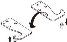
14. Bewegen Sie die obere Tür in geeignete Position, stellen Teil ① und obere Tür, dann fix Teil ① durch Schrauben ②. (Bitte halten Sie die obere Tür von Hand bei der Installation)
