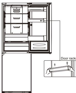
2. aprire la parte di sopra del frigorifero ① dal lato destro e smontare la parte ③ e la parte ④ sopra la porta nello stesso modo. Smontare la parte ② e metterla a posto nella plastica.
