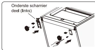
12. Verplaats de onderste deur en stel de positie aan om onderst gat af te stemmen met het bovenste scharnier as. Draai het middelste scharnier in 180, wijzigt de wasser op de as aan de bovenzijde, past u het middelste scharnier aan op de juiste positie en vervolgens installeer het.
