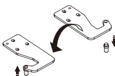
14. Mova a porta superior para a posição adequada, ajuste a parte ① e a porta superior, depois fixe a parte ① com parafusos ②. (Segure a porta com a mão quando instalar)
