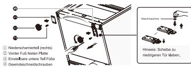
10. Schrauben Sie untere Scharnier, ändern Sie es in der Nähe von Loch und dann vermasseln die Befestigungsscheibe.
