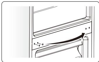
9. Coloque el frigorífico sobre una superficie plana y quite la pieza ③. A continuación, extraiga los tornillos ④.
