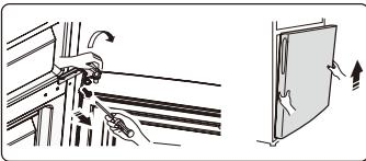
7. Plaats de onderste deur op een gladoppervlak met zijn paneel omhoog. Losse schroeven ③ los deel ② en deel ①. Draai deel ① in 180 ° en installeer dan ① en deel ② aan overeenkomstige positie aan de linkerkant samen met schroeven ③.
