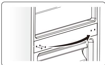
9. Coloque o frigorífico com a parte achatada para baixo, remova a parte ③ e depois desaperte os parafusos ④. Remova a parte ② e a parte ①.
