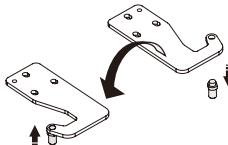
14. Spostare la porta superiore di appropriarsi posizione, regolare parte ① e porta superiore, quindi fissare parte ① con viti ②. (Si prega di tenere sportello superiore a mano durante l'installazione)
