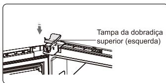
16. Inverta a parte ① 180° e instale-a no canto direito da porta superior, depois instale a parte ②. (ambas são retiradas no passo 2)
