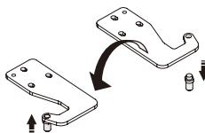
14. Déplacez la porte supérieure à la position appropriée, ajustez la partie ① et la porte supérieure, puis fixez la partie ① par des vis ②. (Tenez la porte supérieure à la main lors de l'installation s'il vous plaît)
