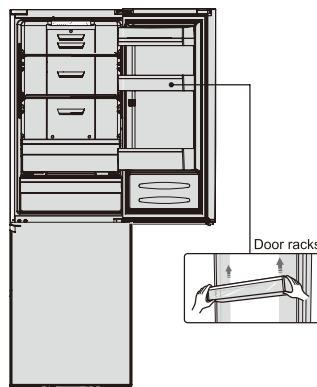
2. Abra a parte ① no topo do corpo do frigorífico do lado direito e depois retire a parte ③ e a parte ④ na porta superior da mesma forma. Retire a parte inferior ③ e volte a colocar no saco plástico.
