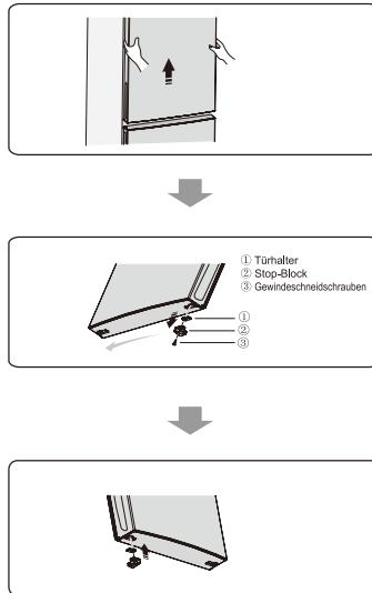
Lose Schrauben werden verwendet, um das mittlere Scharnier zu befestigen und Mitte Scharnier zu entfernen. Dann entfernen Sie die untere Tür.
