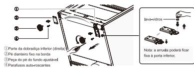
10. Desaperte a dobradiça inferior, mude-a para o sítio do orifício próximo e depois aperte e fixe a arruela.
