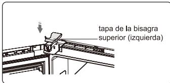
16. Gire la pieza① 180° y móntela en la esquina superior derecha de la puerta. A continuación monte la pieza②. (estas piezas se desmontaron en el paso 2)
