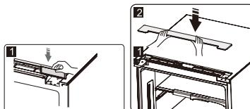
18. Öffnen Sie die obere Tür, montieren Tür mit der Zahnstange und schließen Sie es dann.
