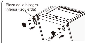
12. Desplace la puerta inferior y ajuste su posición para alinearla con el orificio de abajo y el eje de la bisagra superior. Gire la bisagra central 180°, cambie la arandela del eje a la parte superior, coloque la bisagra central en el sitio y, a continuación, móntela.
