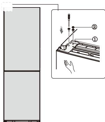
15. Installieren Sie den oberen Teil Scharnierabdeckung (die in der Kunststoffbeutel ist).
