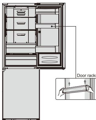
2. Ouvrir de droite la partie ① qui est sur le dessus du corps de réfrigérateur, puis descendre de la même manière la partie ③ et la partie ④ qui sont sur la porte supérieure. Descendez la partie ② et le remettre dans le sac en plastique.
