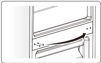
9. Zeigen Kühlschrank plat und nehmen Teil ③ ab und dann lösen Schrauben ④. Entfernen Teil ② und einen Teil ①.
