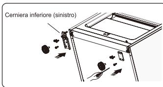
12. Spostare la porta inferiore e regolarne la posizione per allineare sito foro inferiore e l'asse cerniera superiore. Ruotare il cardine centrale di 180, cambiare la rondella sull'asse al lato superiore, regolare la cerniera centrale nella posizione appropriata e poi installarlo.
