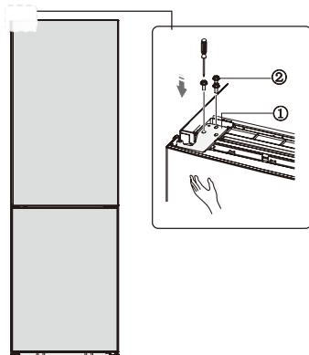
15. Installeer een deel van het bovenste scharnier deksel (die in de plastic zak zit).
