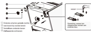
10. Schroef het onderste scharnier uit, verander het in het dichtbij gat plaats, en dan verpest het en installeer de wasser.
